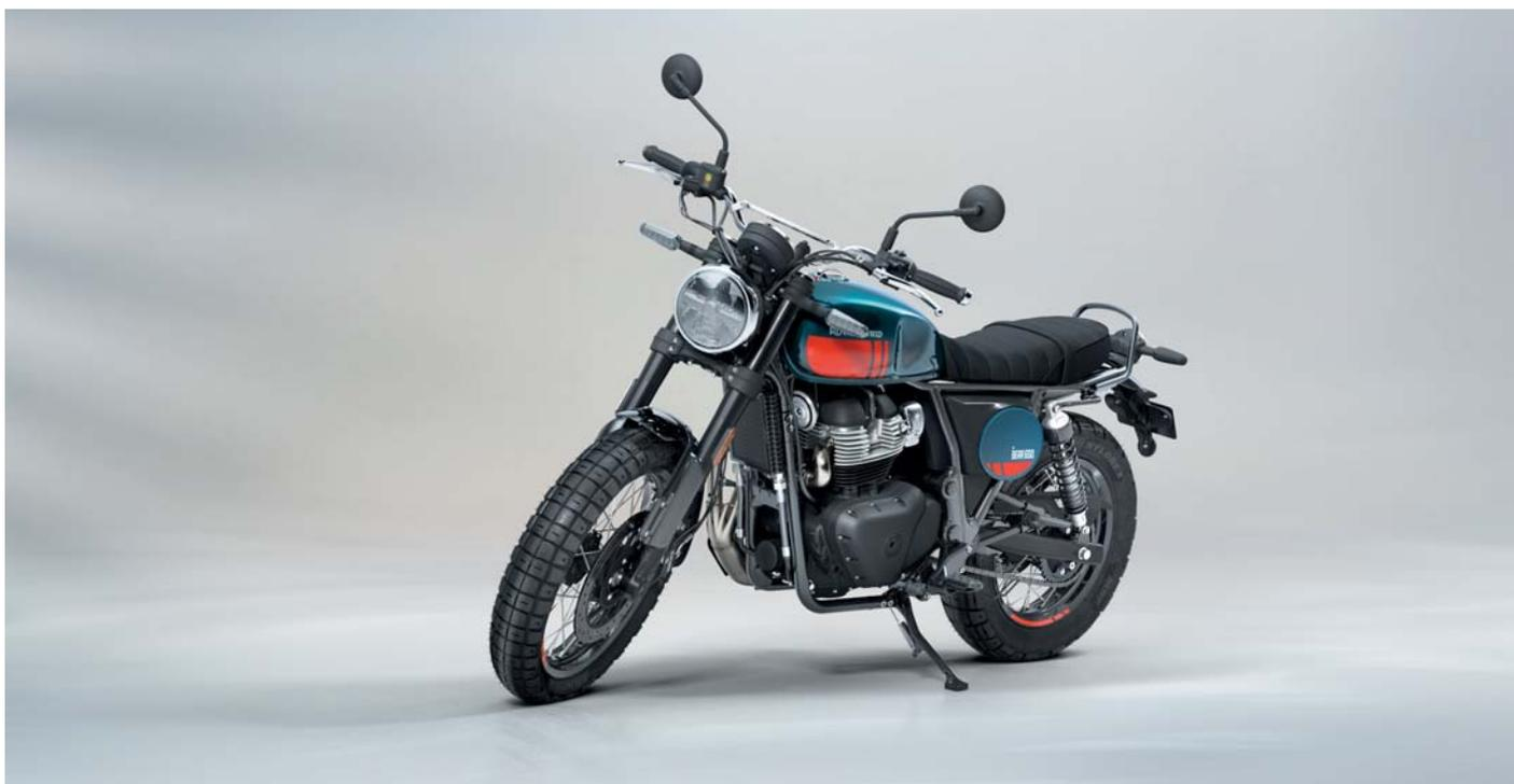
en distintos terrenos. La suspensión delantera Showa con horquillas invertidas de gran pistón y el sistema Showa Twin Tube en la parte trasera ofrecen una conducción ágil y controlada, incluso en superficies irregulares.
